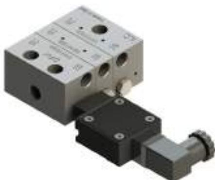
Ce contrôle est constitué par un interrupteur contenu dans un bloc. Le piston qui se déplace dans son logement de fonctionnement ouvre et ferme le contact de l'interrupteur.
